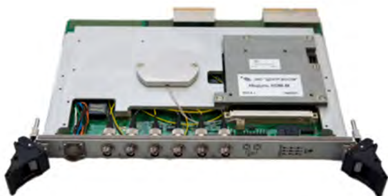
Модуль коммутатора магистрального
